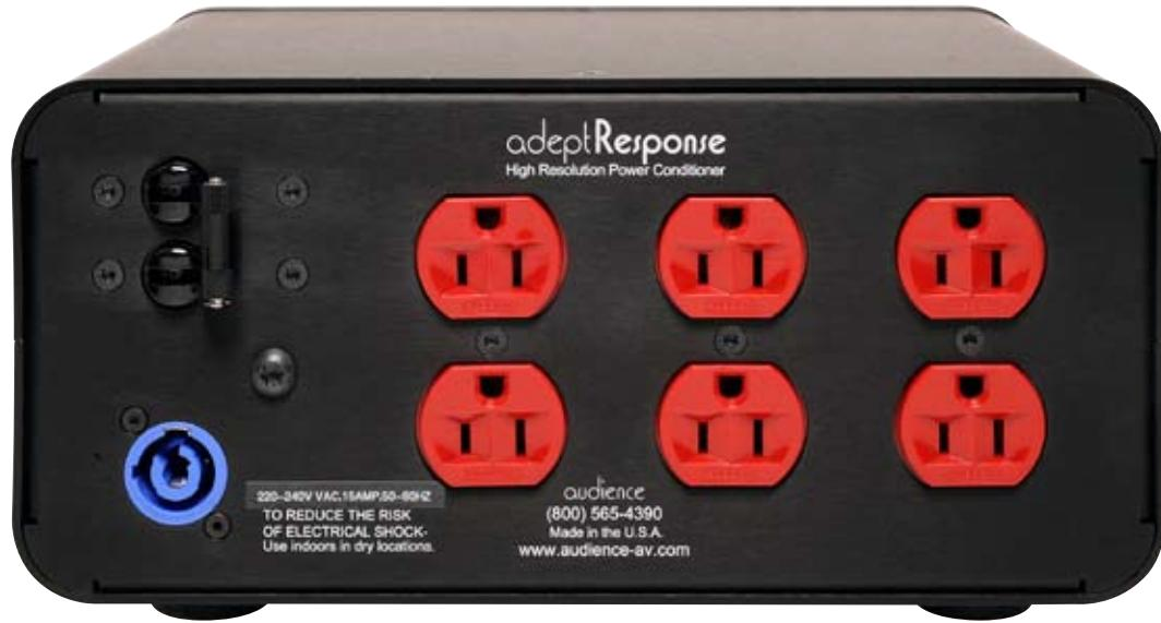
aR6-TS 的每個插座都獨立濾波，插座與插座之間也有濾波，變成雙重濾波，使每件從它取電的器材都有很好的隔離，不會互相影響。最近交流電輸入的插座是為功率放大器的，中間的是為較小電流的前置放大器、調諧器等，而最遠的是為數碼器材，好像 CD 機、解碼器等。
